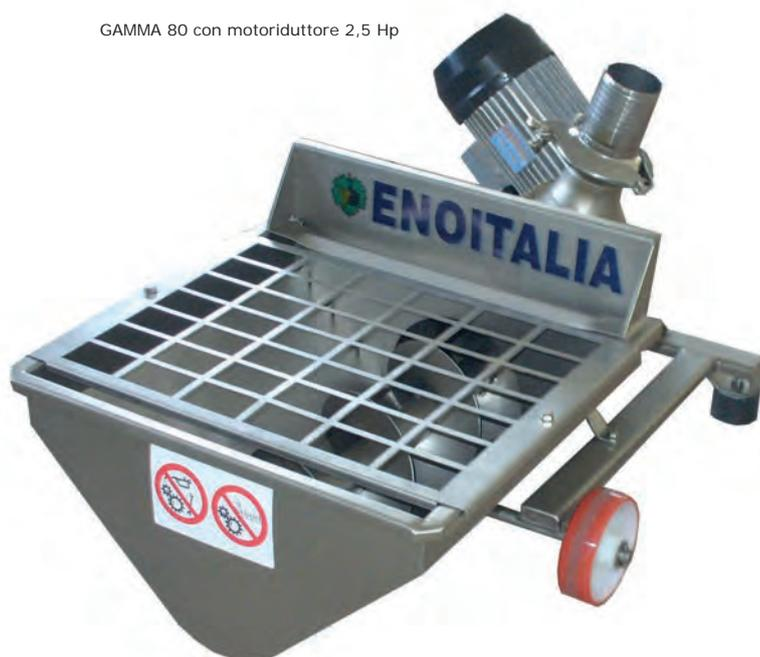
GAMMA 80 con motoriduttore 2,5 Hp
