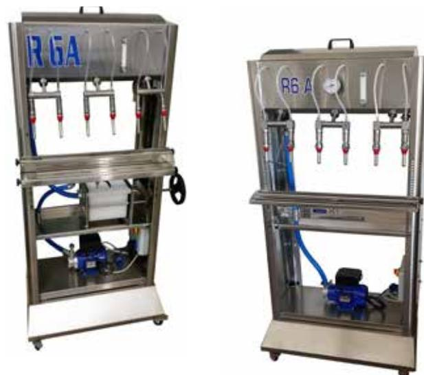
Su tutti i modelli vengono fornite di serie valvole in acciaio inox, piano di appoggio bottiglie regolabile in altezza, indicatore di livello. Su richiesta è possibile dotare il macchinario di: pompa di riempimento (modello Enos 20 in acciaio inox/modello EURO20 con girante in gomma); filtro a cartoni 20x20; elettrovalvola di ingresso; valvola iniezione azoto; kit 100 C° per liquidi caldi pastorizzati; kit ATEX; sistema automatico di lavaggio.
