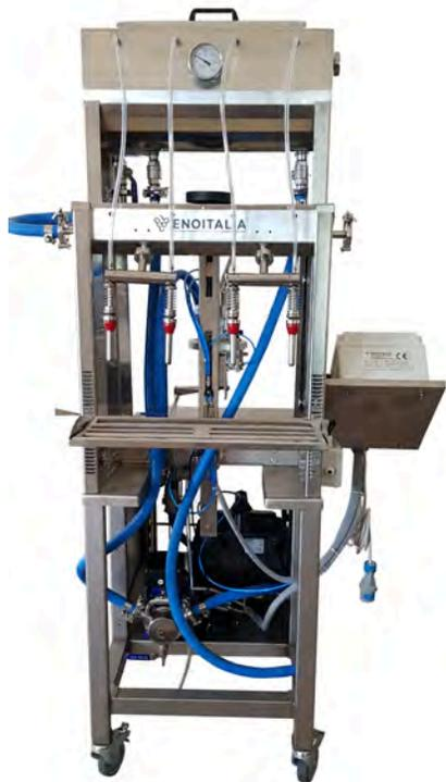
Realizzata in acciaio inox AISI 304, con 4 ruote. Il serbatoio di accumulo viene installato sulla parte superiore della riempitrice e collegato direttamente a un pastorizzatore con un raccordo DIN 25. Collegamento elettrico con un pannello di controllo separato.
