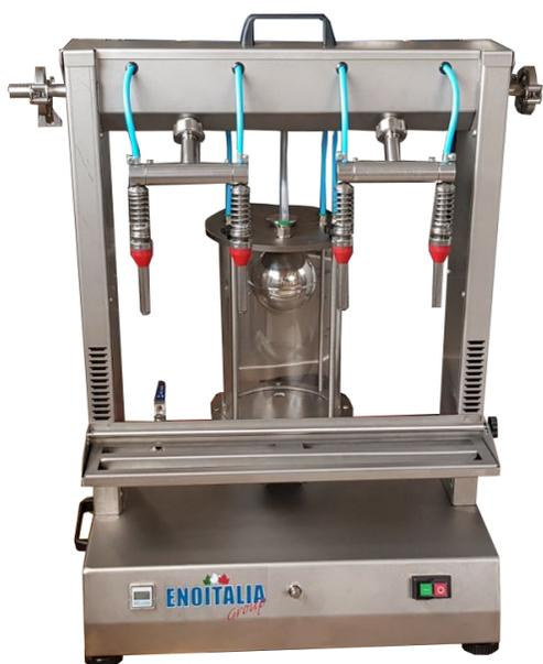
La riempitrice è costruita interamente in acciaio inox. Il macchinario è dotato di un sistema elettrico per la depressione all'interno dei contenitori, in modo da creare un'aspirazione delicata del liquido da riempire senza l'utilizzo di pompe. Indicato per il riempimento di soli contenitori rigidi.
