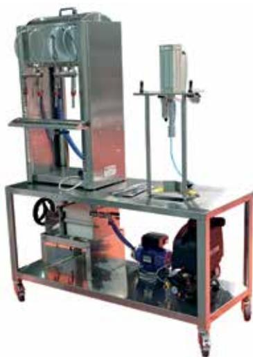
Monoblocco semimanuale di riempimento e tappatura componibile sulle specifiche del cliente. Il sistema è composto di un banco in acciaio inox AISI 304 su ruote con lunghezza 1400 oppure 2000mm; una riempitrice per bottiglie disponibile sia nella versione a gravitazione sia nella versione a depressione; un sistema di tappatura che può essere selezionato tra tappi sughero (sia nella versione pneumatica sia nella versione motorizzata), tappi a vite, tappi corona.
