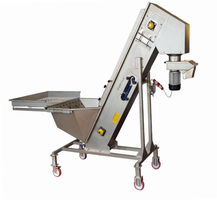
La linea automatica per la lavorazione delle mele comprende una prima postazione di scarico e selezione (tavolo rimuovibile da 1mt) e lavaggio mele (tramoggia di carico dotata di griglia di separazione).
