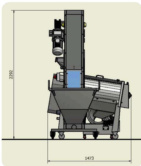
La polpa pulita viene ulteriormente filtrata dal macchinario ROTOFILTER, che segue una separazione a 0,3mm tra il succo e la polpa pulita. La resa di questa linea è di oltre il 95%, con una percentuale di succo di circa il 60% (varia in base alla frutta lavorata) e un 40% di polpa pulita pronta all'uso.
