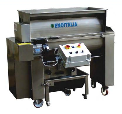
Diraspapigiatrice professionale studiata per una lavorazione delicata e soffice, nel massimo rispetto dell'uva. Consente di eliminare completamente i raspi senza strapparli e/o tagliarli, allontanandoli perfettamente integri. Consente di effettuare una separazione progressiva e delicata degli acini conservandone l'integrità.
