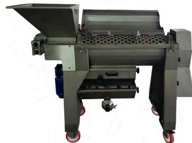
Il macchinario è predisposto per l'installazione di una vasca di raccolta con doppio attacco laterale e coclea centrale di omogenizzazione. In alternativa alla vasca di raccolta può essere installata qualsiasi tipologia di pompa con tramoggia di carico, come le nostre pompe a rotore ellittico, monovite, peristaltiche.
