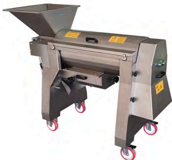
Diraspa-pigiatrice centrifuga ideale per piccole cantine di qualità, con raccolta manuale. Completamente in acciaio inox, priva di pompa centrifuga di travaso.
