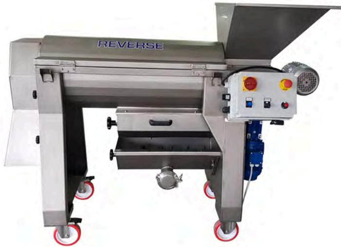
Per le operazioni di pulizia il macchinario è completamente apribile centralmente, con possibilità di estrazione sia dell'albero che della rete di diraspatura. Il gruppo rulli e la vaschetta di raccolta sono completamente rimovibili.
