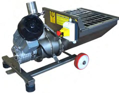
La pompa a rotore ellittico in acciaio inox, dotata di ampia tramoggia di carico, è idonea al pompaggio di uva intera, diraspata e vinacce fermentate. Il trasferimento dell'uva avviene per pressione e non per forza centrifuga, assicurando il migliore trattamento possibile del prodotto, evitando la rottura dei raspi e la frantumazione delle bucce e dei vinaccioli. Il carrello in acciaio inox con sistema antivibrante permette di spostare ed installare con facilità il macchinario.
