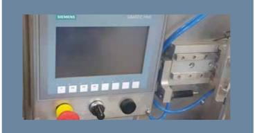
PRECISIONE: il quadro comandi dotato di PLC SIEMENS consente di gestire tutte le fasi del riempimento, adattando il macchinario a qualsiasi tipologia di liquido trattato (vino, succhi di frutta, olio, acqua, creme, ecc..). La funzione AUTOTUNING consente la calibrazione del macchinario in automatico, eliminando la necessità di effettuare le campionature. Ripetitibilità dei volumi con errore di ±0,5/0,2%.
