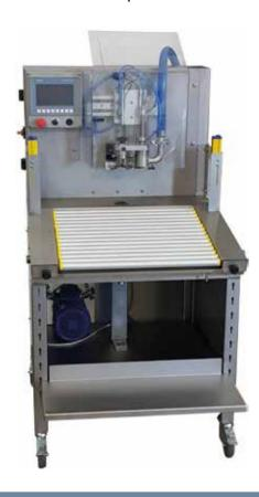
ALTRI VANTAGGI: ampio piano di appoggio con rulli di scorrimento e supporto regolabile di appoggioscatola di cartone; vassoio raccogli gocce con scarico totale; utilizzo pompe volumetriche autoadescanti con valvole di scarico totale; display da 7"; programmazione multilingua; compressore silenziato oiless (optional), polmone di accumulo laterale (optional).
