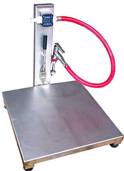
Riempitrice manuale per sacchetti Bag in Box, costruita completamente in acciaio inox con 4 piedi regolabili, predisposta per l'installazione su di un banco di appoggio, non necessita alcuna alimentazione elettrica e pneumatica.
