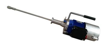
Agitatore universale per collegamento laterale, con albero ad asta retraibile in acciaio inox ed elica pieghevole ad apertura automatica. Questa soluzione permette l'installazione e lo smontaggio del macchinario direttamente su serbatoi pieni, attraverso valvole a passaggio totale, senza perdita di liquido e senza l'utilizzo di utensili.
